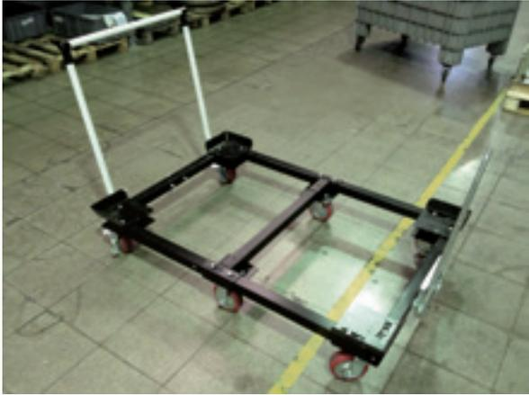
Unsere High-Load-Palette ist die ideale Lösung für hohe Lasten oder für den Umschlag von modularen Wagen oder Durchlaufregalen mit Gabelstaplern. Unsere High-Load-Anwendungen eignen sich zur Erstellung von Lenkgrundlagen für Züge, die durch Schlepper gezogen werden.
