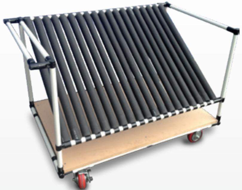
Die Shooter-Wagen sind für den schnellen Transfer von Behältern zwischen Wagen und Regalwagen ausgelegt. Flexible und einfache Lösungen für den Umschlag von Materialien aller Art, die mit einer Zugstange oder einer Anhängerkupplung ausgestattet sind. Breites Sortiment an kombinierbaren Rollen, auch in ESD-Ausführung erhältlich. Die Lösungen sind auch für hohe Lasten erhältlich.
