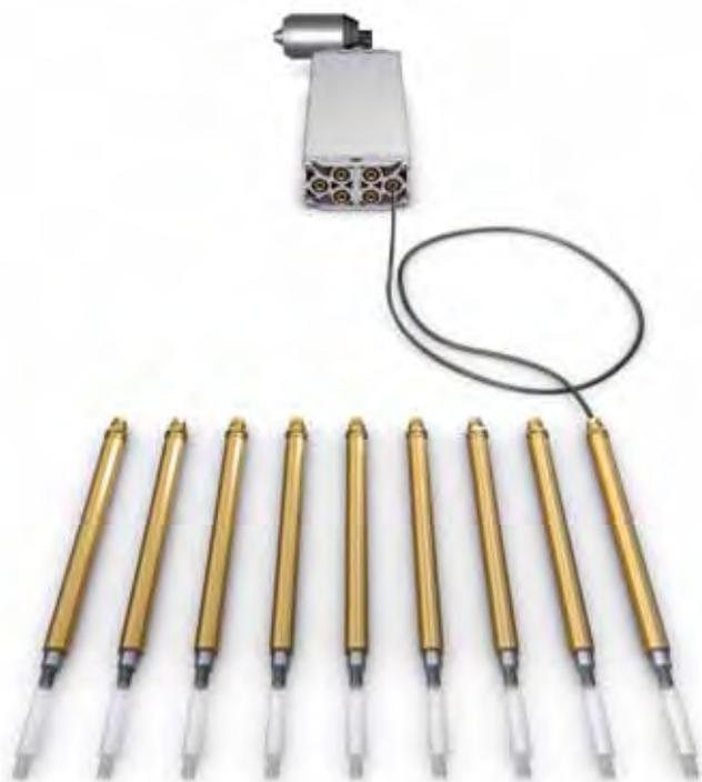
Le fluide est poussé de la pompe par la commande vers les vérins (jusqu'à 10 vérins), qui s'allongent. Le principe hydraulique simple effet exige un effort externe d'au moins 50 N (5 kg) pour le retour du fluide dans la pompe.
