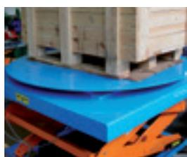
Dispositivo di rotazione motorizzato
