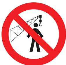
Vietato sostare nel raggio d'azione della macchina
