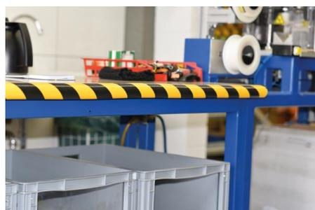
I paracolpi in schiuma di poliuretano sono particolarmente resistenti e in grado di sostenere temperature tra i  $-40^{\circ}\text{C}$  a  $+100^{\circ}\text{C}$ , compresa anche all'umidità, diventando estremamente versatili per uso sia interno che esterno.
