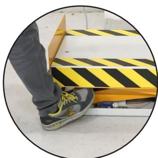
Protezione da sovraccarico e sistema di sicurezza antischacciamento
