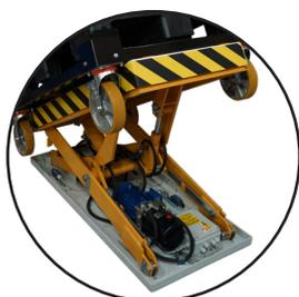
Sistema elettroidraulico a bassa manutenzione
