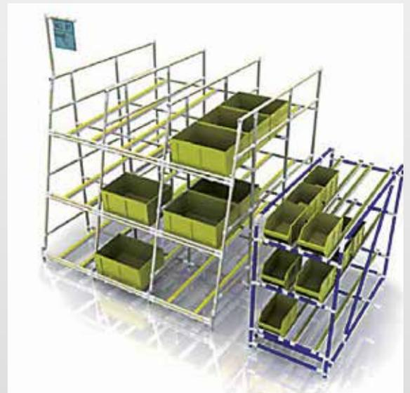
Dank der Supermarktregale mit frontaler Kommissionierung stehen alle Komponenten für die direkte Kommissionierung durch den Arbeiter in ergonomischer Position zur Verfügung. Auf den Rollen gibt es auch einen regelmäßigen Fluss an Kisten und die Möglichkeit, den Rücklauf der leeren Behälter optimal zu managen.
