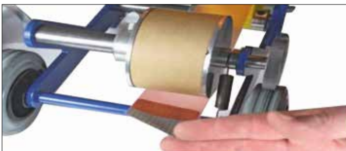
Schritt 6 Führen Sie die Schicht wie abgebildet unter die Walze. Befestigen Sie sie vorne an der Stange zum Einholen des Bandes.
