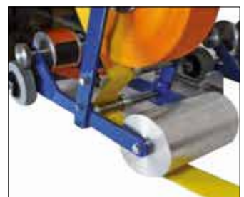
Schritt 7 Fahren Sie mit dem Auftragen der Klebeschicht auf den Boden fort und achten Sie darauf, dass sie unter der Aluminiumrolle hindurchgeht.
