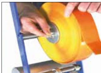
Vergewissern Sie sich, dass die Richtung des Klebebandes stimmt.
