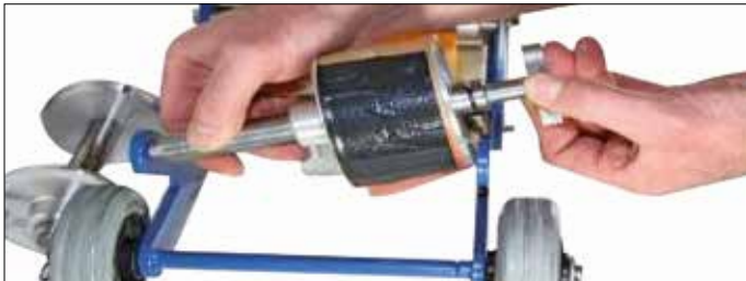
Schritt 3 Befestigen Sie den Federkolben vorne im U-Schlitz und verbinden Sie ihn an der unteren Stange
