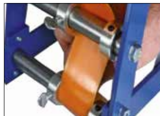
Schritt 5 Schieben Sie das Klebeband durch die Führungen und lösen Sie die Deckschicht.
