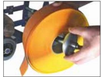
Schritt 4 Befestigen Sie oben den Abroller für das Klebeband.
