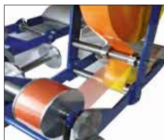
Schritt 7 Fahren Sie mit dem Auftragen der Klebeschicht auf den Boden fort und achten Sie darauf, dass sie unter der Aluminiumrolle hindurchgeht.
