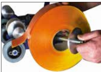
Vergewissern Sie sich, dass die Richtung des Klebebandes stimmt.
