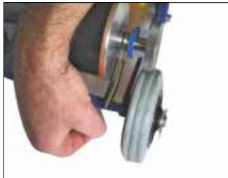
Schritt 1 Sichern Sie die Feder mit dem mitgelieferten Werkzeug.
