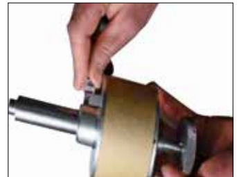
Schritt 2 Befestigen Sie die Spindel in ihrem Gehäuse mithilfe der mitgelieferten Mutter.
