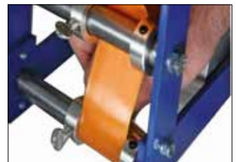
Schritt 5 Schieben Sie das Klebeband durch die Führungen und lösen Sie die Deckschicht.
