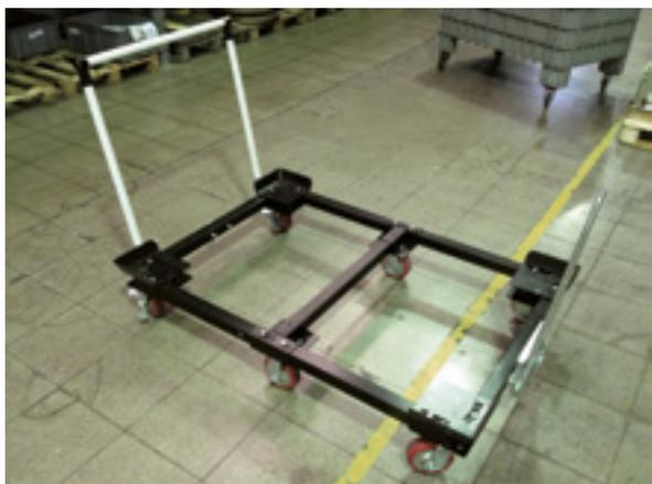
La nostra gamma high load è la soluzione ideale per portate elevate o per movimentare carrelli o flow racks modulari mediante carrelli elevatori. Le nostre applicazioni high load si rivelano idonee a realizzare basi sterzanti per treni trainati da motrice.
