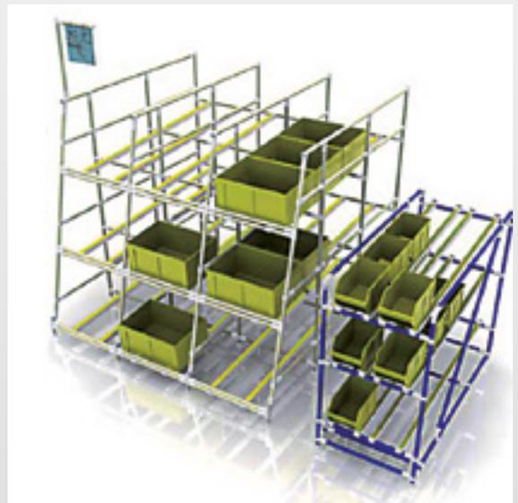
Grazie a supermarket a picking frontale tutti i componenti sono a disposizione per il picking diretto da parte dell'operatore in posizione ergonomica. Si ha inoltre un regolare flusso delle cassette sulle rulliere e la possibilità di gestire il ritorno dei vuoti in maniera ottimale.
