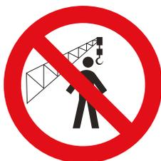
Vietato sostare nel raggio d'azione della macchina
