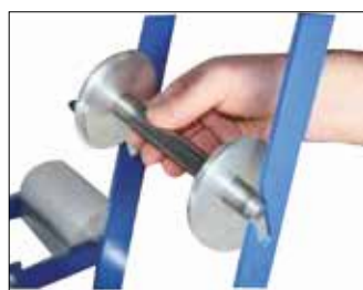
Step 4 Fissare il dispenser nastro superiore.
