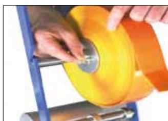
Assicurarsi che la direzione del nastro sia corretta.
