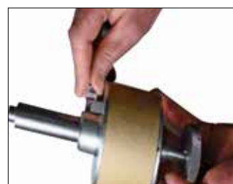
Step 2 Fissare il mandrino nel suo alloggiamento servendosi della dadi in dotazione.
