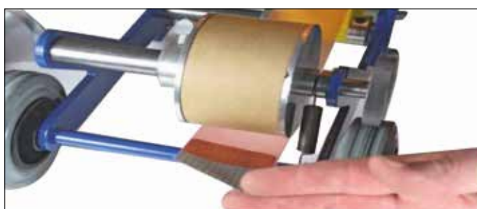
Step 6 Fare passare il rivestimento sotto al rotolo come illustrato. Fissare il rivestimento all'asta anteriore di recupero nastro
