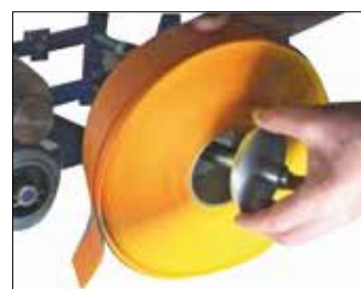
Step 2 Fissare il mandrino nel suo alloggiamento servendosi della dadi in dotazione.
