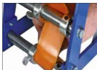
Step 5 Fare scorrere il nastro attraverso le guide e staccare lo strato di rivestimento dal nastro.
