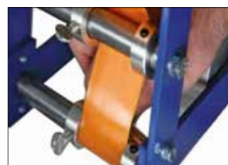
Step 5 Fare scorrere il nastro attraverso le guide e staccare lo strato di rivestimento dal nastro.
